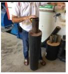
【写真3:地域熱供給システムの 熱導管】
